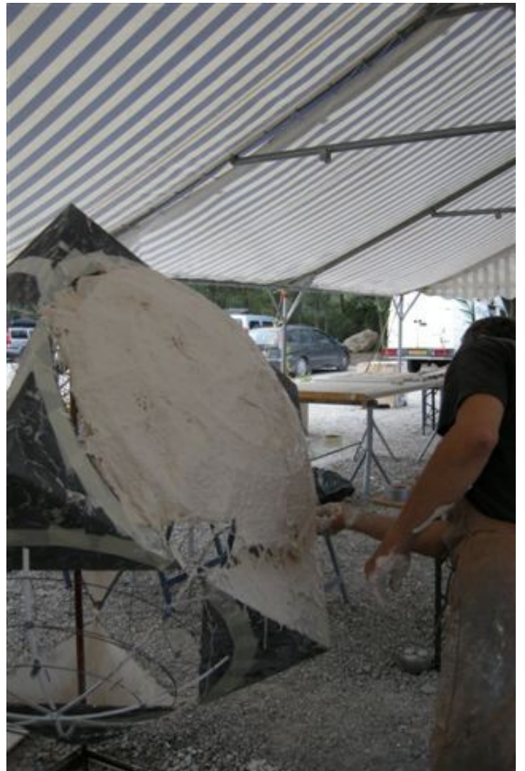
mise en forme de la sphère avec des tiges de plexi glass. Réalisation de l'enduit au plâtre
